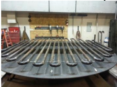
タンクに内蔵されたヒーティングコイルを点検
