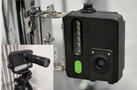
バッテリー駆動、かつ無線ネットワーク通信(LTE)が利用できるため、電源・ネットワーク工事不要で即日起ち上げ可能です。「専用の取付金具」と「遠近・広角レンズオプション」が柔軟かつ安心強固な設置をサポートします。
